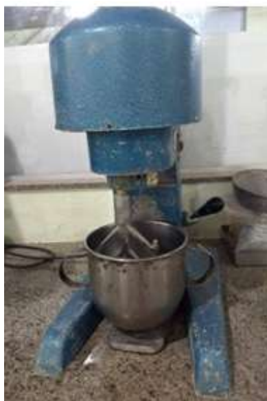
Figura 3. Argamassadeira eletro-mecânica, marca Contenco, modelo I 3010
