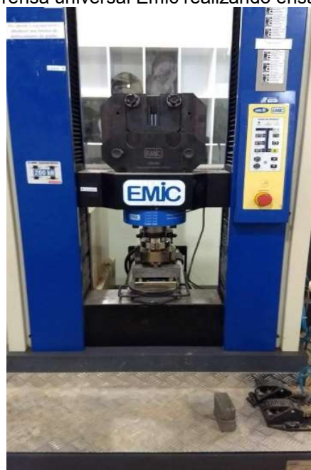
Figura 7. Prensa universal Emic realizando ensaio de flexão
