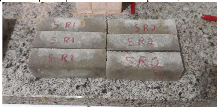
Figura 6. Corpos de prova mistura com adição de 5,0% de resíduo
