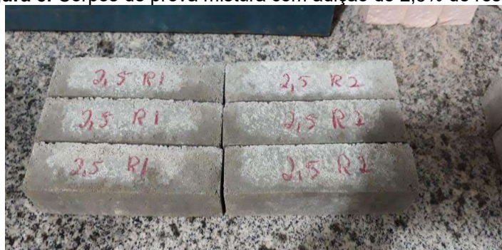
Figura 5. Corpos de prova mistura com adição de 2,5% de resíduo
