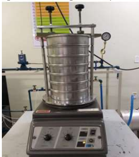
Figura 2. Agitador eletro-magnético de peneiras da Bertel
