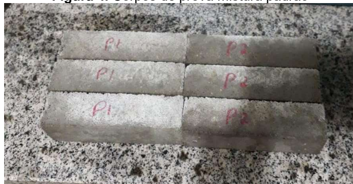
Figura 4. Corpos de prova mistura padrão
