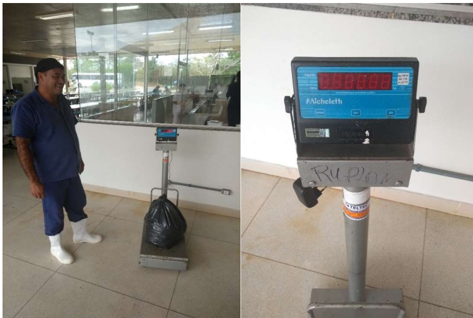
Figura 2: Modelo da balança utilizada para pesagem dos resíduos orgânicos à esquerda e funcionário do restaurante pesando os Resíduos da Refeição dos Usuários (RRU) à direita.
