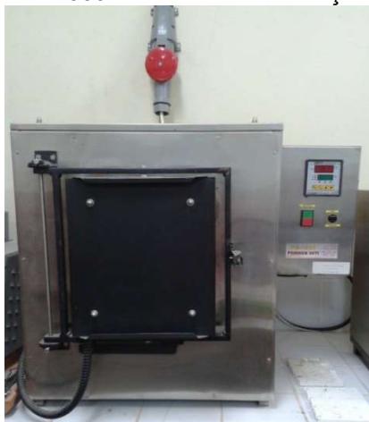
Figura 6. Forno INTI FE-1500 utilizado na sinterização dos corpos de prova
