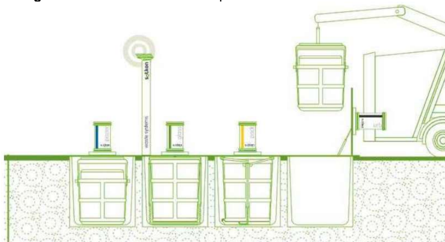
Figura 4. Coleta dos resíduos depositados nas lixeiras subterrâneas
