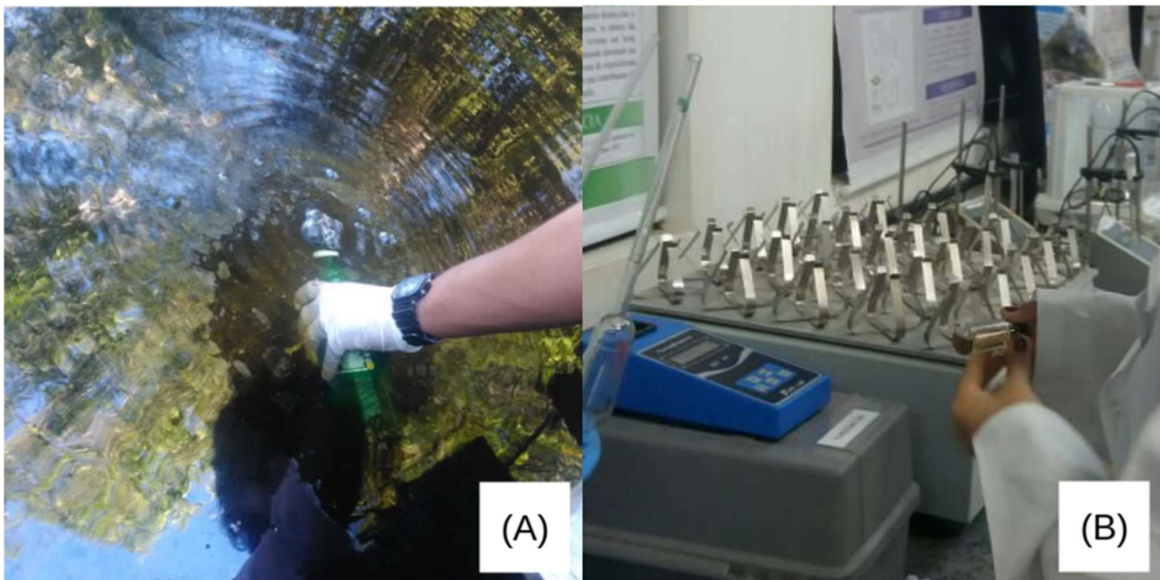
a) Coleta das amostras e b) Análise da turbidez
