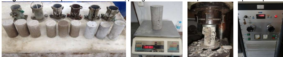
Figura 2. Fotos do processo de desmolde, pesagem e teste de compressão dos corpos de prova.
