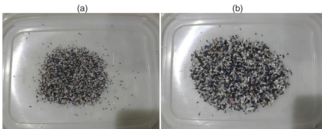
Figura 2: Frações obtidas após a separação granulométrica (a) Amostra 1 e (b) Amostra 2
