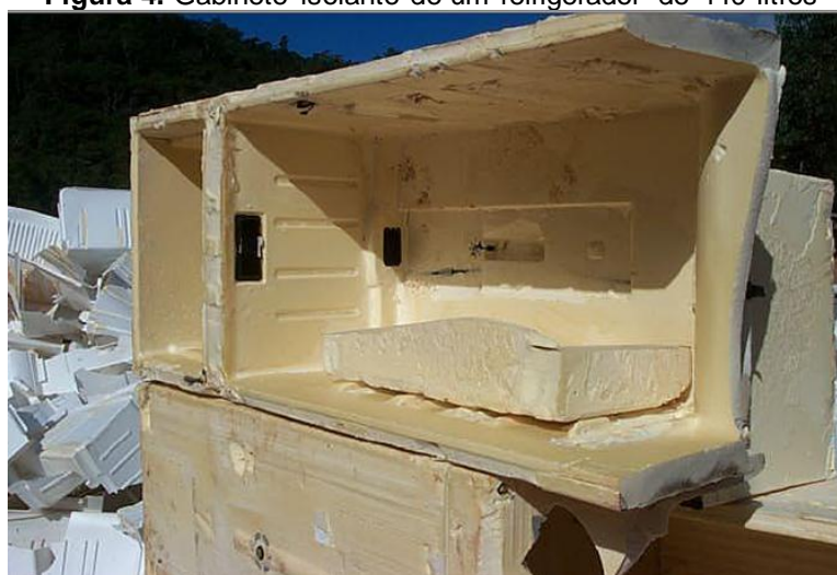
Figura 4. Gabinete isolante de um refrigerador de 440 litros
